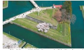
五稜郭の正面入口を防御するための出塁。西洋式土壘に特徴的な三角形状の土壘で、馬出塁（うまだしる）ともいう。当初の設計では各稜堡間の5カ所に配置されていたが、工事規模の縮小などから、最終的に正面の1カ所のみ造られた。
